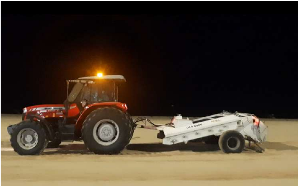
Figura 15: Serviço de limpeza de faixa de areia: trator com equipamento para peneiramento da areia e sucção de resíduos
