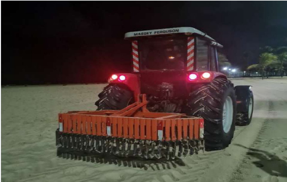
Figura 15: Serviço de limpeza de faixa de areia: trator com equipamento para peneiramento da areia e sucção de resíduos
