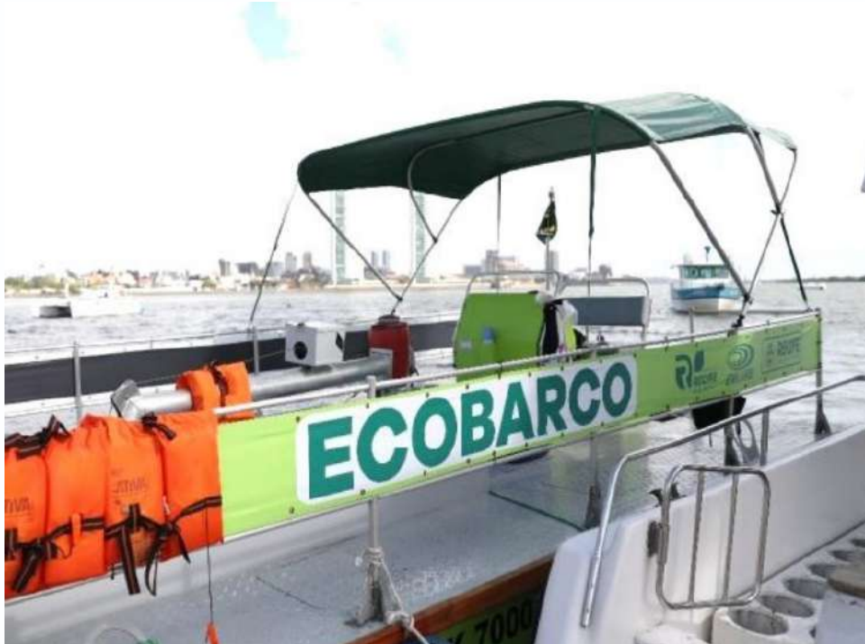
Figura 19: Ecobarco utilizado para coleta de resíduos flutuantes em rios e vias navegáveis em Recife – PE
