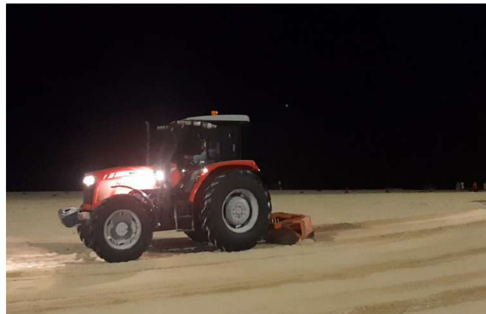
Figura 13: Serviço de limpeza de faixa de areia: rastelagem com trator sendo executada
